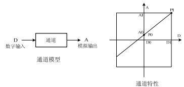
设置通道特性的目的是为了调整模块的现场线性误差，由于模块使用环境温度的不同及使用连接电缆的原因，会带来误差，用户可以通过设定通道特性来消除此类误差。
